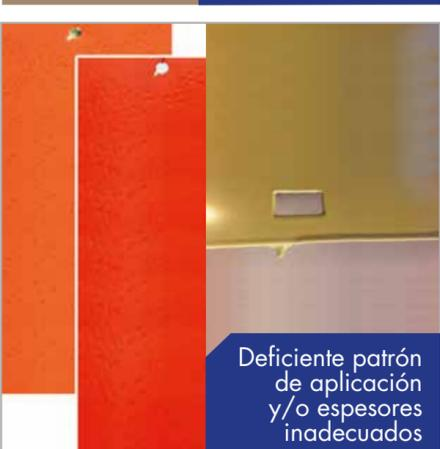
Deficiente patrón de aplicación y/o espesores inadecuados  | Desgaste y/o falla en el sistema de aplicación.         | <ul style="list-style-type: none"> <li>Revisar el estado de limpieza y/o mantenimiento</li> <li>Ajustar los parámetros de tensión en KV y/o corriente en amperios.</li> </ul>                  |
