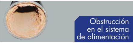
Obstrucción en el sistema de alimentación                  | Acumulación y/o fusión de pintura en el sistema.        | <ul style="list-style-type: none"> <li>Disminuir el flujo de aire del sistema.</li> <li>Garantizar la correcta limpieza del sistema.</li> <li>Cambiar piezas desgastadas.</li> </ul>           |
