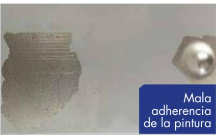
Mala adherencia de la pintura           | Polvillo en la superficie/Exceso de capa de conversor. | Remover los lodos, renovar los enjuagues y ajustar los parámetros.   |
