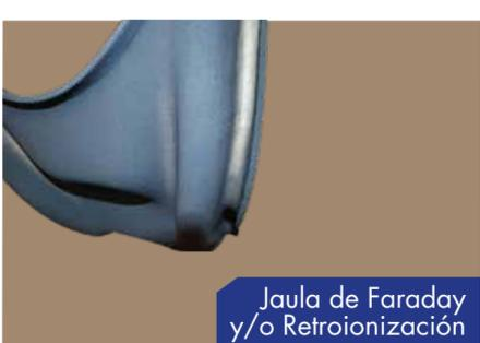
Jaula de Faraday y/o Retroionización                       | Cavidades y/o geometrías complejas.                     | Ajustar los parámetros de las pistolas y de la conexión a tierra.                                                                                                                              |
