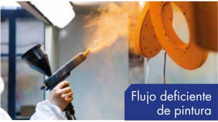
Flujo deficiente de pintura                                | Baja fluidización/Obstrucción en el sistema de pintura. | Revisar estado de limpieza y/o mantenimiento del sistema de pintura.                                                                                                                           |
