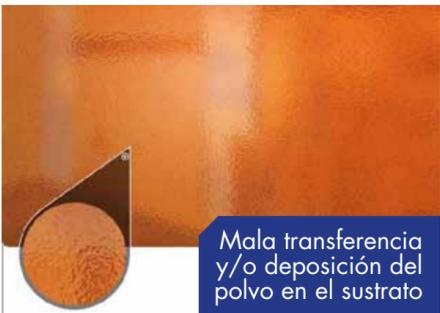
Mala transferencia y/o deposición del polvo en el sustrato | Condiciones de carga inadecuadas.                       | <ul style="list-style-type: none"> <li>Ajustar los parámetros de las pistolas y de la conexión a tierra.</li> <li>Revisar el estado de limpieza y/o mantenimiento de las pistolas.</li> </ul>  |
