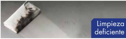
Limpieza deficiente                     | Temperatura y concentración en los baños deficiente.   | Garantizar que las condiciones de los baños son las requeridas.      |
