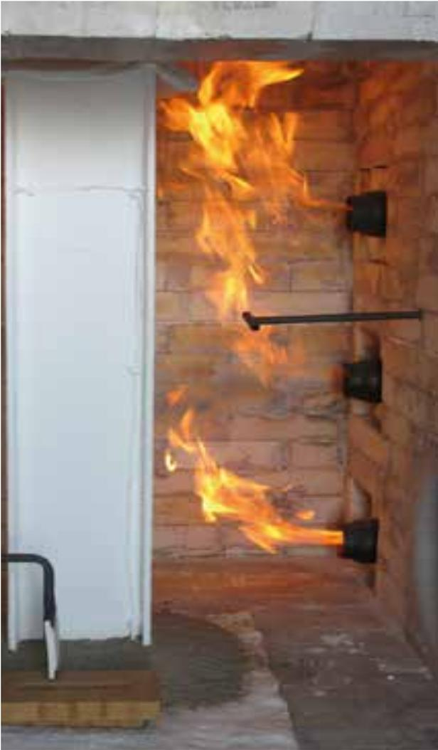
Las columnas en el horno antes de la prueba
