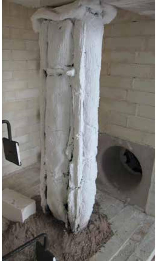
Las columnas en el horno después de la prueba
